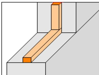
Reprise de bétonnage // Construction joints
