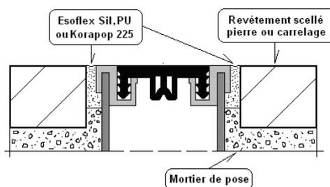
**ATTENTION :** Ces profils ne sont pas adaptés aux dallages industriels devant répondre à des contraintes de poinçonnement importantes, occasionnés par des engins de type fenwick > 2T sur bandage plein.
