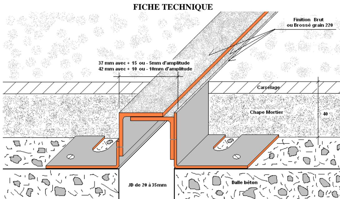
**Esoflat TGV 9041 est un système d'obturation des joints de dilatation de sols jusqu'à 35mm d'ouverture, à sceller, soumis à des agressions de type chimique ou climatique.**
