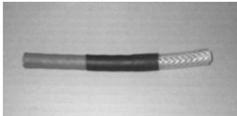
Assemblage Tube arme et Esoject
